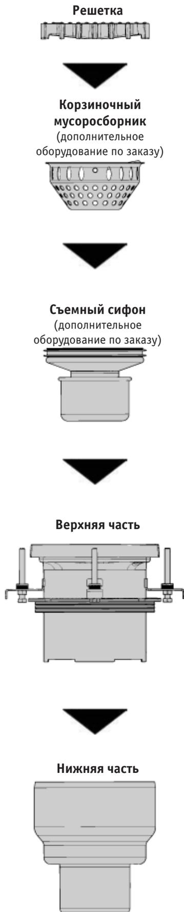
Схема сборки универсального трапа BLÜCHER Industrial® со вспомогательными элементами в полнофункциональный модуль
